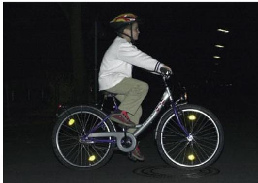
Eine Federgabel oder gar Vollfederung ist dagegen nicht notwendig. Sie macht das Rad unnötig schwer. Ein bei jedem Wetter störungsfrei arbeitender Nabendynamo und eine Halogenlichtanlage dagegen stellen einen echten Sicherheitsgewinn dar. Moderne Lichtanlagen haben oft eine Standlichtfunktion integriert. Aufstecklampen ohne Dynamo sind im Straßenverkehr nur für Rennräder unter 11 kg und Mountain-Bikes unter 13 kg erlaubt.
